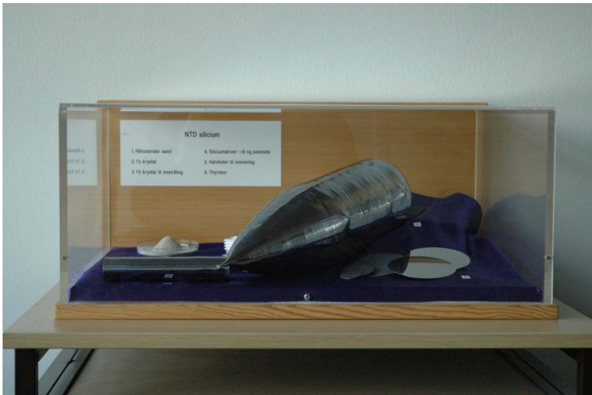
Billede 2. I montren ses en enkeltkrystal af FZ-silicium. Til højre herfor ses tynde polerede skiver af NTD-silicium – såkaldte ”wafere” – der er udgangspunktet for produktion af halvlederkomponenter. Forfatterens foto.
