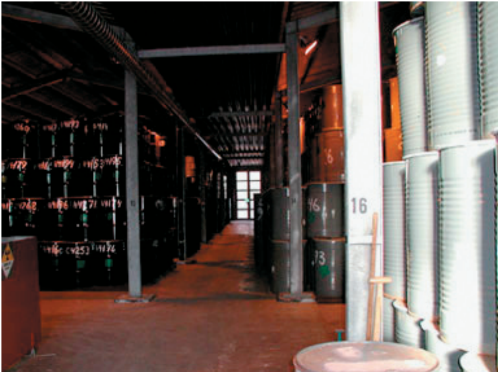
Figur 2. Oplagrede tromler med radioaktivt affald på Behandlingsstationen på Risø
